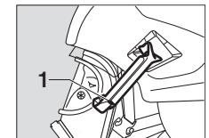
**Dichtheit prüfen:** Maskenanschluss dichthalten und einatmen, bis ein Unterdruck entsteht. Luft kurzzeitig anhalten. Der Unterdruck soll bestehen bleiben. Dichtprüfung zweimal wiederholen.
