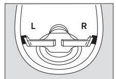
**Einatemventil sichtprüfen:** Das Einatemventil ist im Maskenanschluss sichtbar. Durch Hineinblasen prüfen, ob die Einatemventilscheibe frei beweglich sind. Falls verklebt austauschen.
